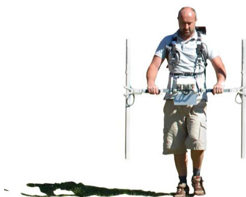
Utilisation d'un magnétomètre © Canterbury Archaeological Trust
