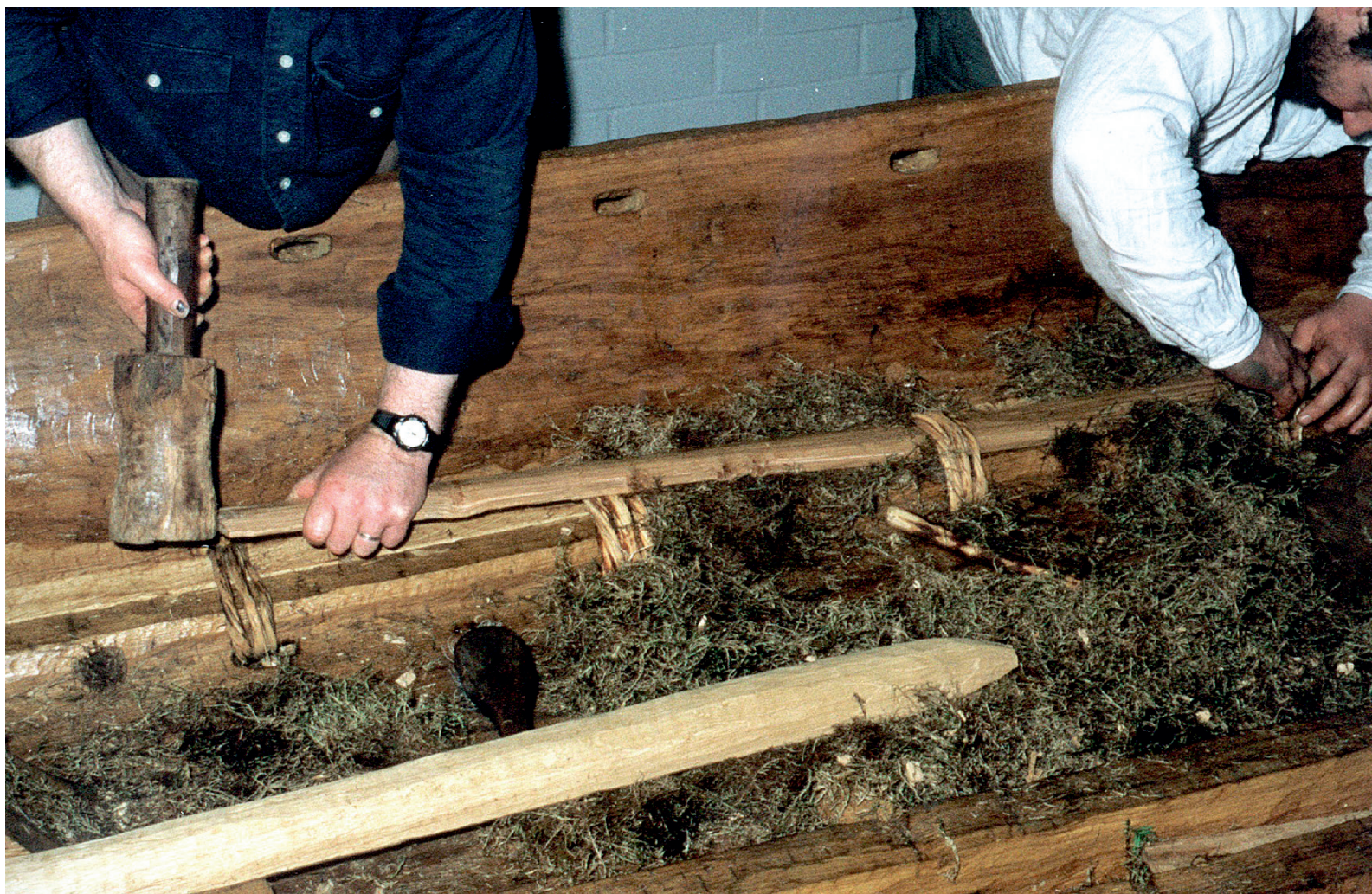
Fig. 41. Travail de calfatage à l'aide de mousses
