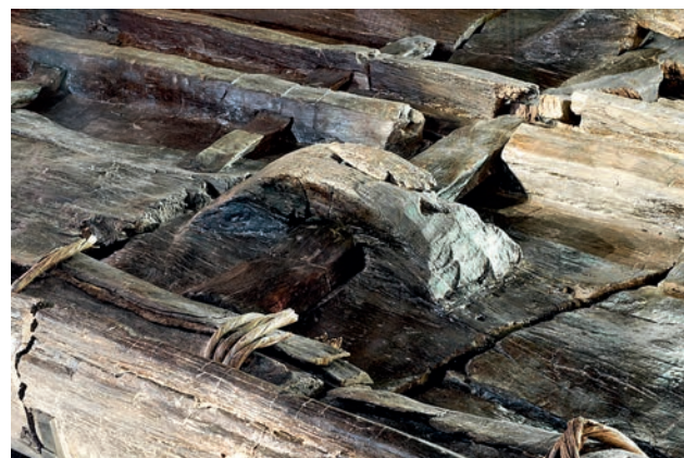
Fig. 54. Détail des taquets et des cordes torsadées d'attache utilisées pour la fixation des différentes pièces du bateau
