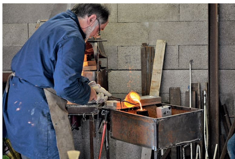
Fig. 80. La coulée lors de l'expérimentation faite par Jean Dubos, artisan bronzier
