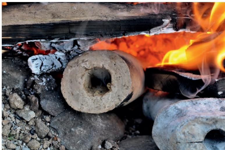
Fig. 74. Moule en céramique de l'expérimentation ; au début de sa cuisson, l'humidité s'en échappe comme l'atteste la fumée.
