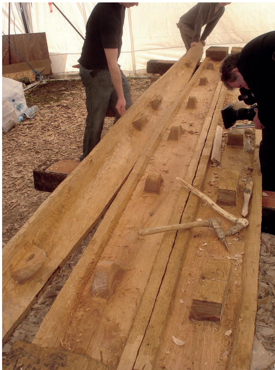
Fig. 39. Travail de rapprochement des pièces principales du bateau lors de la construction de la réplique 1/2 en 2012
