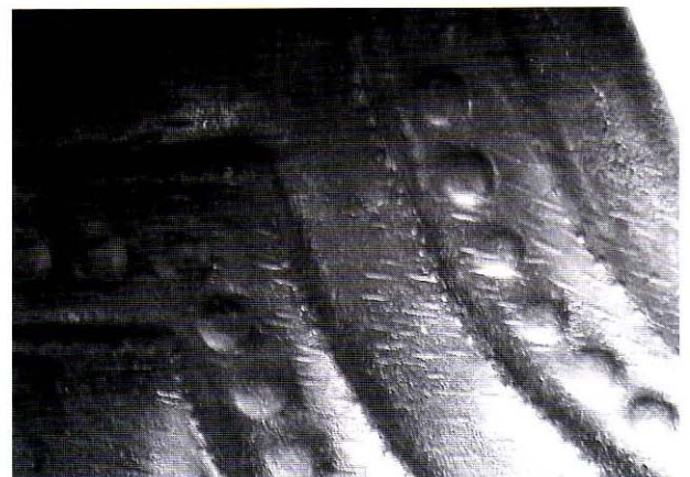
Fig. 5 : Vue interne de la cuirasse 83754 où l'on distingue les traces de martelage sous forme de petites lentilles (photographie A. Lehoërrf).
